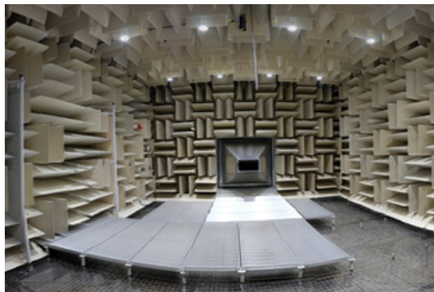
Salle anéchoïque et soufflerie au GAUS
