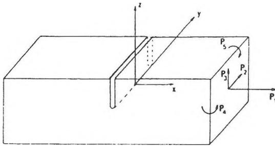
figure 1. élément de poutre chargé avec une fissure transversale
