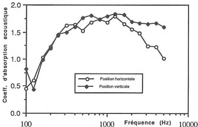
Figure N°2: Comparaison entre les montages horizontal et vertical.
