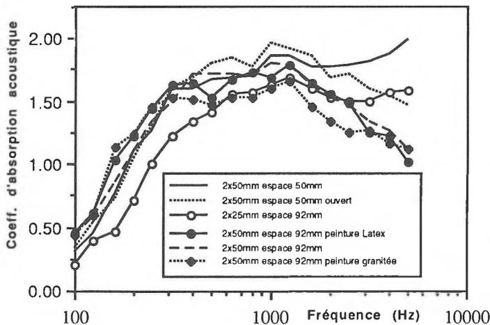
Figure N°1: Absorption des différents échantillons horizontaux.
