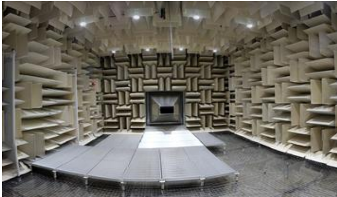
Salle anéchoïque et soufflerie au GAUS
